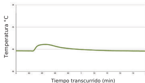
Recuperación tras abrir la puerta durante 1 minuto
